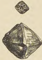
Fig. 101. Diamant: Oktaeder, kombiniert mit dem Rhombendodekaeder, oben in nat. Größe ( 0.355g = 1\frac{3}{4} Karat), unten vergr.
